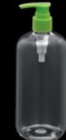
WSP-500A/500ml 螺牙尺寸:Φ24/410 瓶身高度:167mm 瓶身直径:70mm 瓶身克重:35.0g
