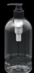
WSV-750/750ml 螺牙尺寸:Φ28/410 瓶身高度:180mm 瓶身直径:84mm 瓶身克重:50.0g
