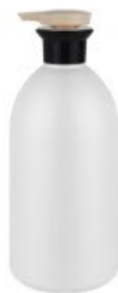
WYY-CY1000/1000ml 螺牙尺寸:Φ32/410 瓶身高度:201mm 瓶身直径:92.5mm 瓶身克重:70.0g
