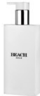
WYF-BP300/300ml 螺牙尺寸:Φ24/410 瓶身高度:158mm 瓶身直径:68.5*34.5mm 瓶身克重:60.0g
