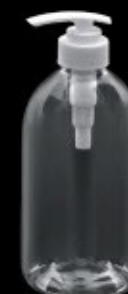
WSP-750/750ml 螺牙尺寸:Φ28/410 瓶身高度:192mm 瓶身直径:80mm 瓶身克重:50.0g
